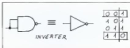
Figura 7 - Un invertitore, realizzato servendosi di una NAND. L'uscita di due porte di accoppiamento sempre in condizioni identiche di un circuito combinato. Se la condizione di B è un livello logico zero (0) e se il livello di A è 1 (1) l'uscita è 0.
